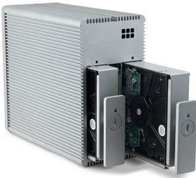
Unità RAID composta da due dischi fissi. Lavorando in modalità mirroring, ciascuno dei due dischi registra gli stessi dati.
