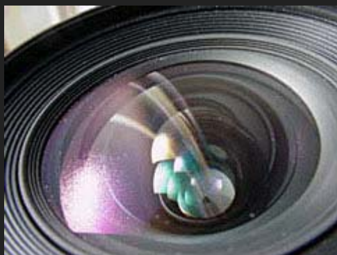
Il multicoating provoca fenomeni di interferenza luminosa che "colorano" diversamente i vari obiettivi. Anche questo è un sistema per verificare se l'ottica che si sta usando (o che si vuole acquistare) è stata sottoposta a trattamento antiriflesso.
