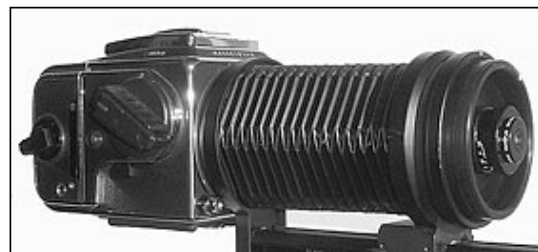
Nella foto a sinistra è illustrato il risultato finale: l'obiettivo è montato sul soffietto Hasselblad e questo, mediante adattatore, su una reflex Canon
