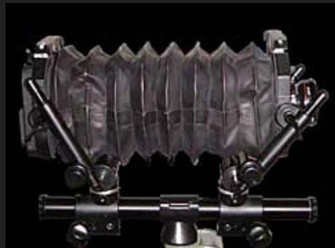
Basculando le standarte alla base in avanti e sull'asse all'indietro, in modo da riportarle verticali, si può estendere il soffietto al di là dei limiti fisici della rotaia di banco.
