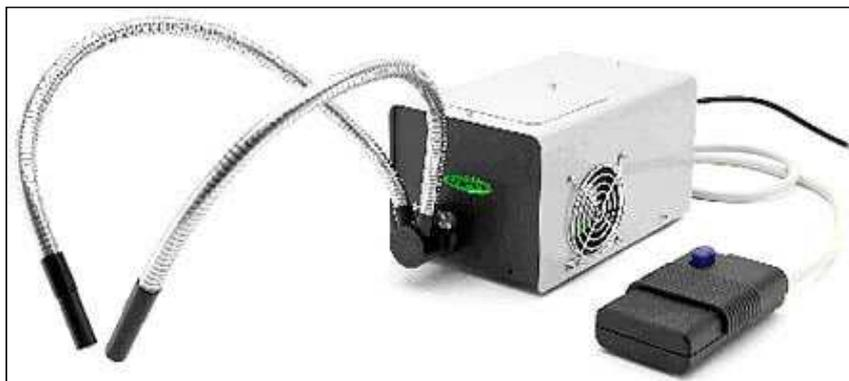
*Un illuminatore a luce fredda basato sulla tecnologia delle fibre ottiche.*
