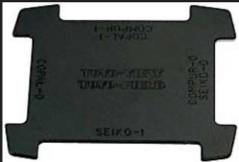
Non sono strumenti di tortura rinvenuti nel sotterraneo di qualche castello diroccato ma aggeggi che servono ad avvitare e svitare l'anello di tenuta dell'otturatore per avvitarlo alla (o rimuoverlo dalla) piastra portaottica. Ovviamente possono adattarsi ai diversi diametri (Copal #0, #1 e #3, Prontor, Compur eccetera).
