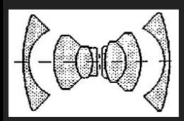
Schema ottico dello Schneider Super-Angulon 65 mm f/5,6: anche in questo caso otto elementi in quattro gruppi secondo il classico disegno simmetrico. Come un 17 millimetri nel formato 4x5 pollici; come un 28 millimetri nel formato 6x9. Il 65 millimetri è un obiettivo sorprendente, e non solo per il fotografo di architettura.
