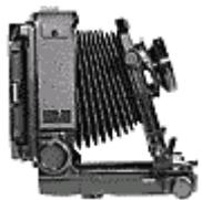
Questa volta abbiamo l'esigenza di enfatizzare la forma e le dimensioni di una roccia in primo piano. Soluzione: basculaggio del dorso all'indietro: allontanando la parte superiore del dorso dall'ottica si enfatizzeranno forma e dimensioni del primo piano:
